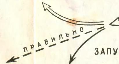
ЕСЛИ МОДЕЛЬ РЕЗКО СНИЖАЕТСЯ — СЛЕДУЕТ УМЕНЬШИТЬ БАЛЛАСТ (ИЛИ ПОДНЯТЬ ВВЕРХ ЗАДНЮЮ КРОМКУ СТАБИЛИЗАТОРА)
